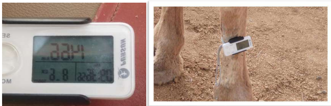
Figure 9 : podomètre électronique fixé sur la chamelle
