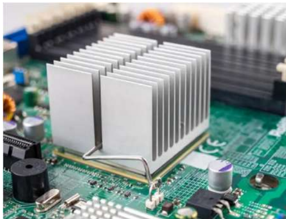
Figure. I.6 : Refroidissement des composants électroniques par des ailettes.
