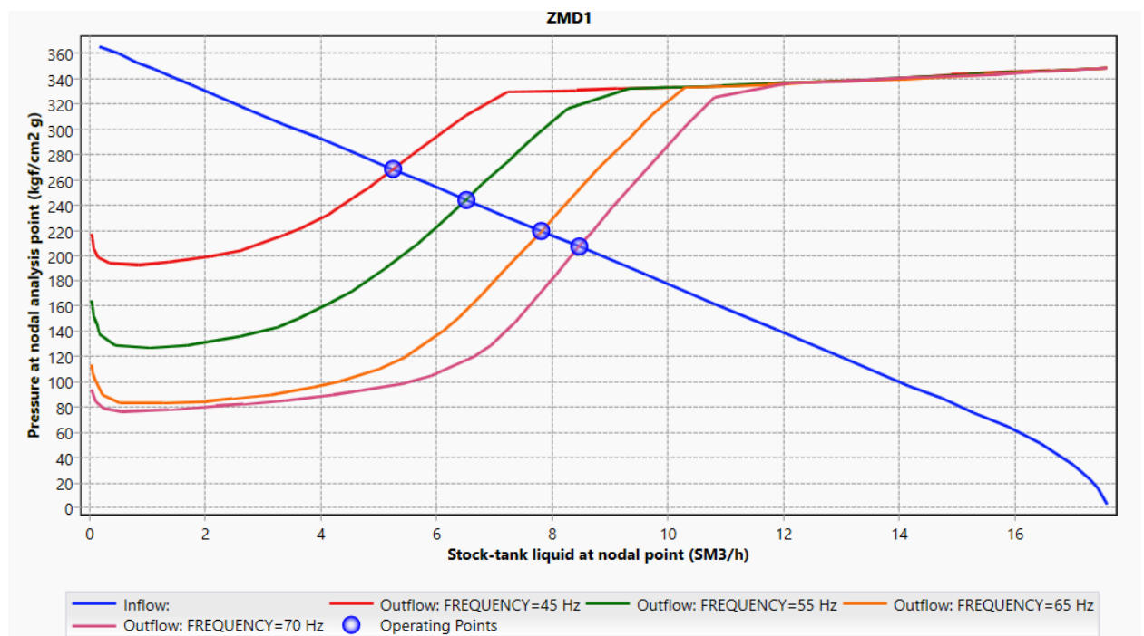
Figure V. 7 : Courbes de performance de RC 1000 pour des fréquences variables
