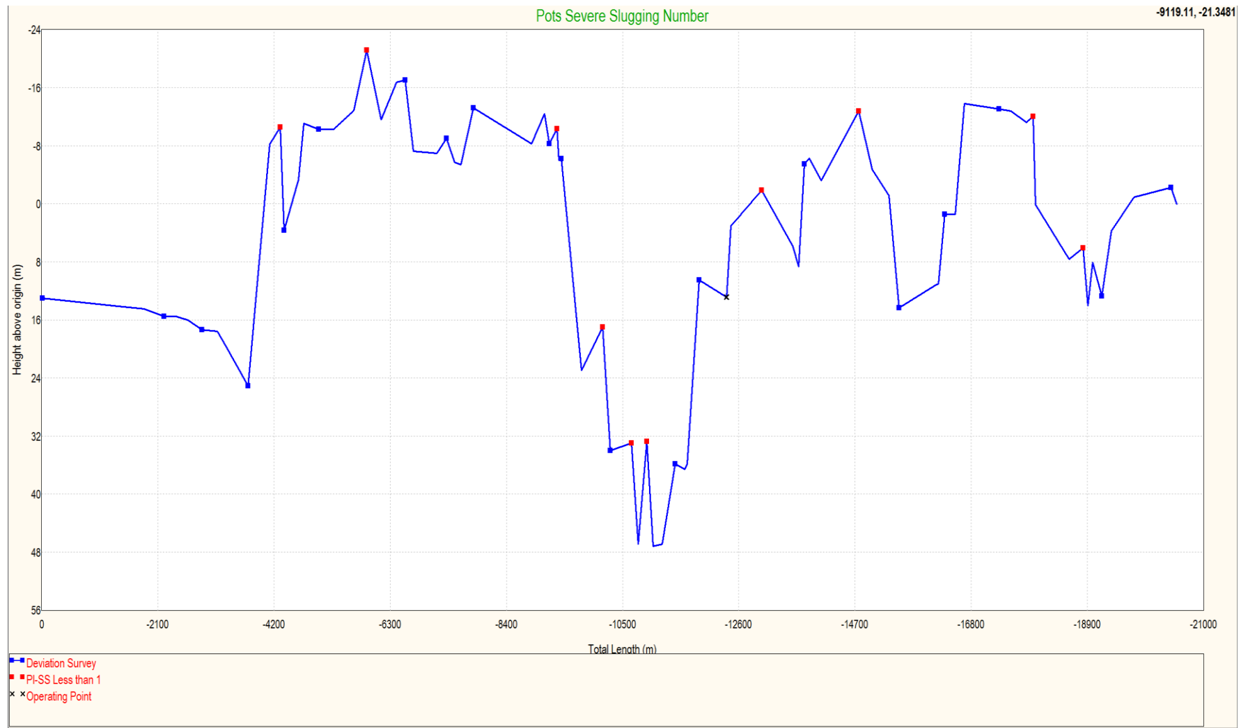
Figure IV-21 Courbe du changement de régime d'écoulement
