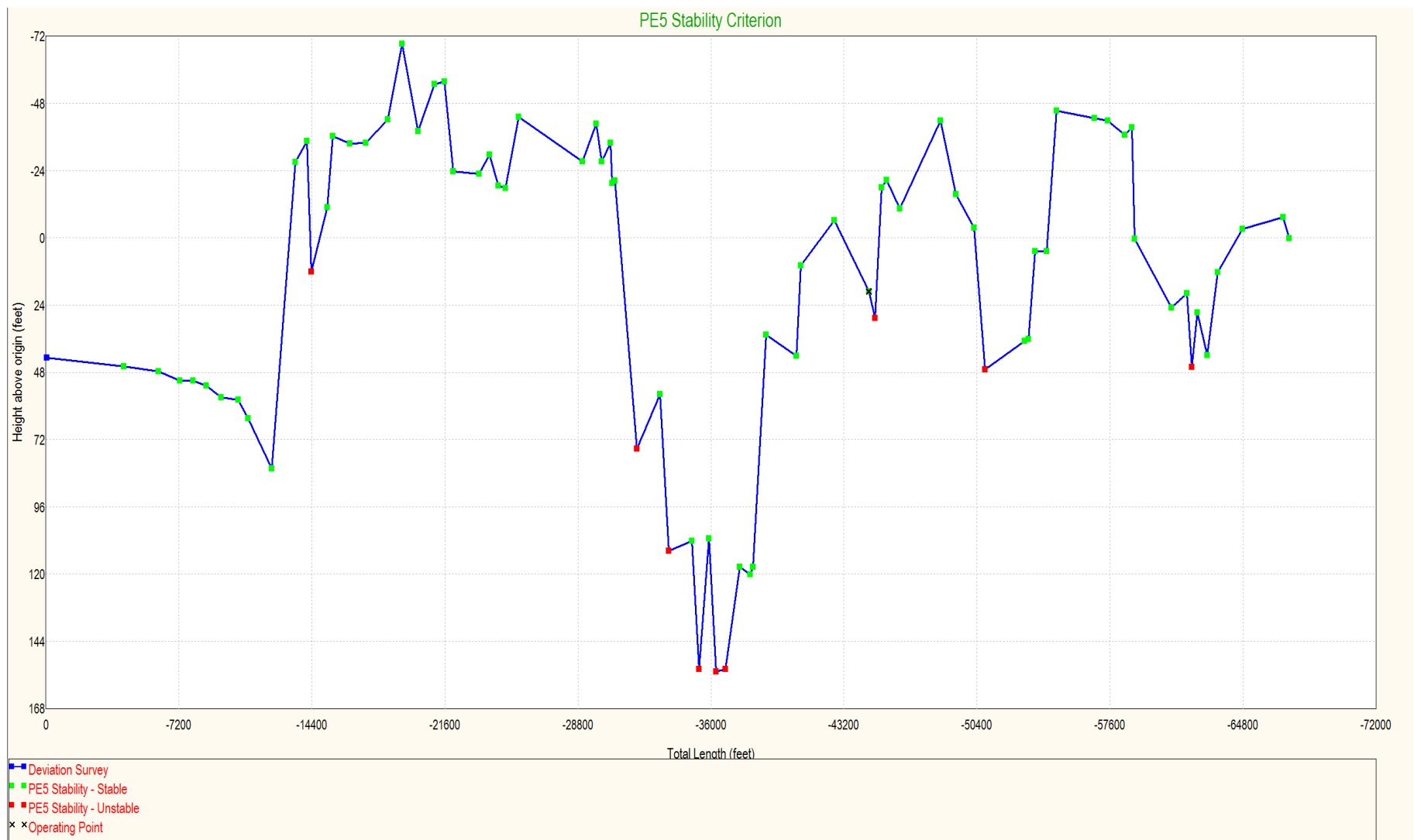
Figure IV-22 la stabilité de l'écoulement à travers les deux trunkline
