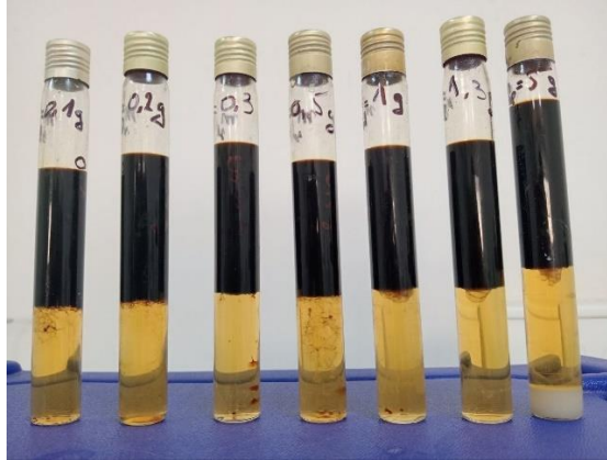
Figure 28 III,3 : Microémulsion dans des différentes gammes de salinité.
