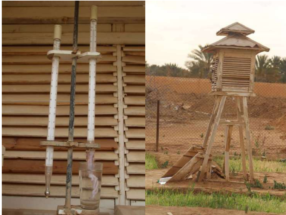
Figure 27. Thermomètre sec ; Thermomètre humide. Abri météorologique (à droite).
