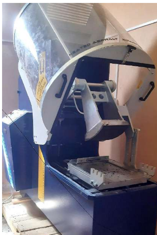
Figure VI. 12. Compacteur pour préparation des éprouvettes de l'essai d'orniérage
