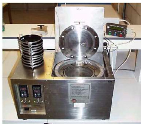
Figure II. 11. Processus & Equipements pour l'essai PAV [33]
