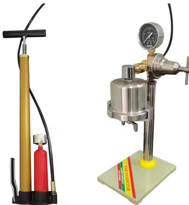
Figure III.9 : Filtre-presse API à pression moyenne pour boue de fluide de forage [42].
