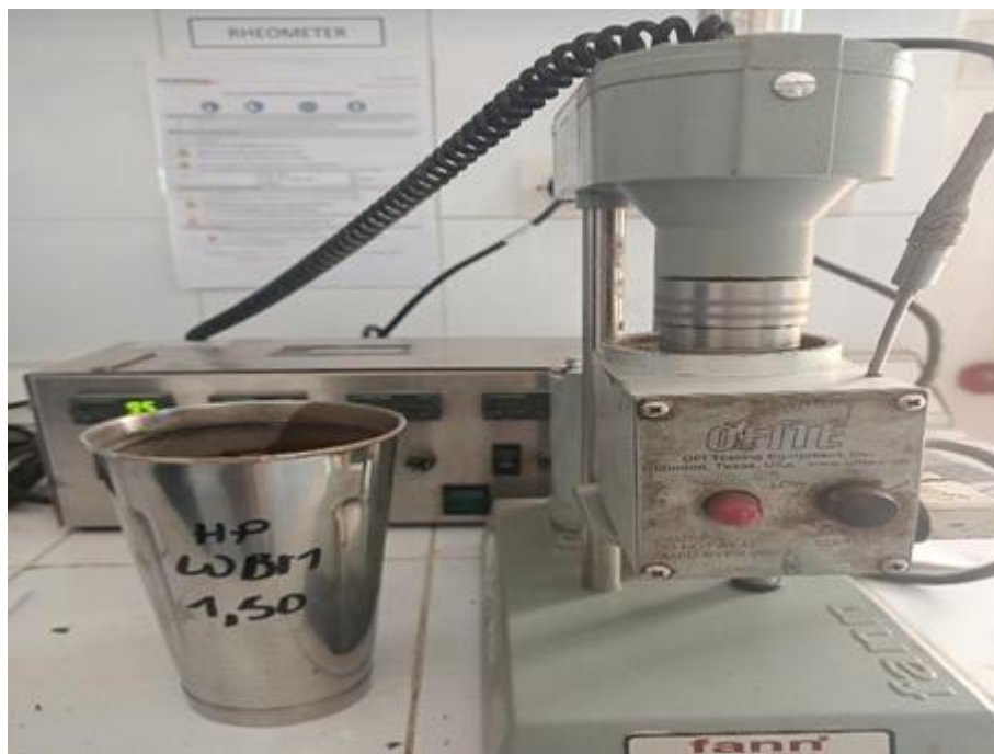
Figure III.21 :Essai au viscosimètre Fann(Ghouini. A, Lamniai. A).
