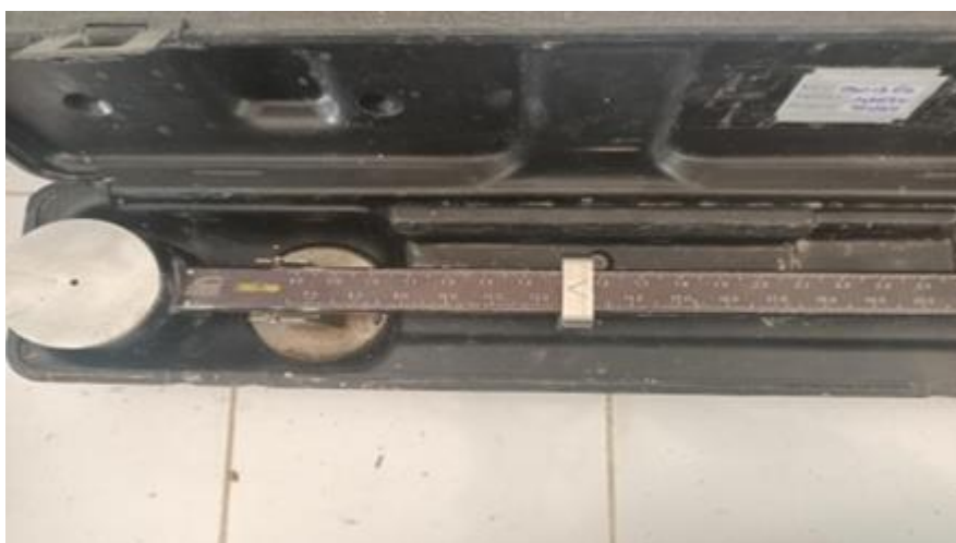
Figure III.20 : Balance à boue utilisée pour la mesure de densité(Ghouini. A, Lamniai. A).
