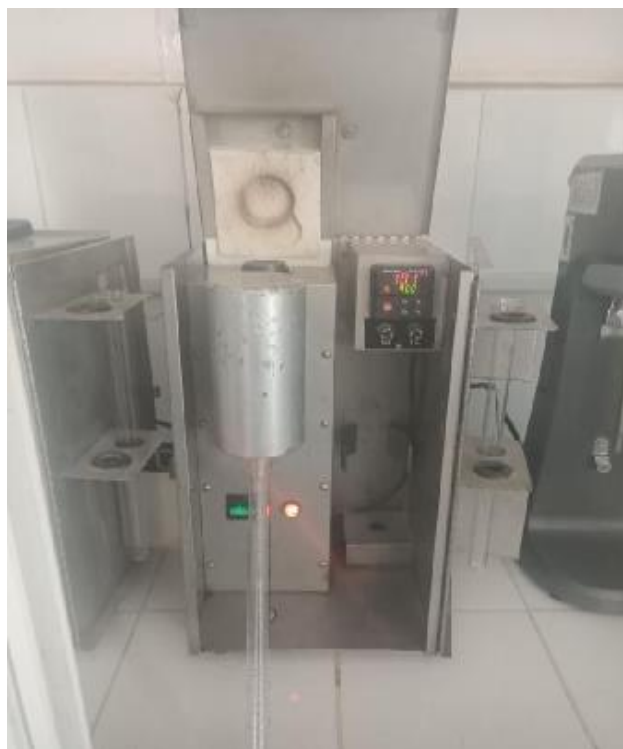
Figure III.22 : Appareil de distillation (Retort) utilisé pour l'analyse (Ghouini. A, Lamniai. A).
