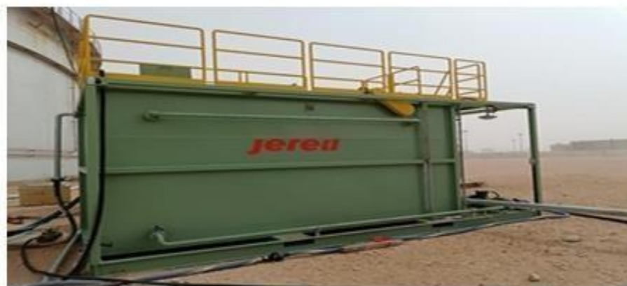
Figure III.21: Réservoir de Séparation d'Huile
