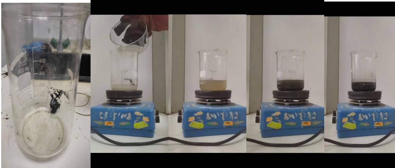
Figure III.33 : les étapes de traitement par toluène
