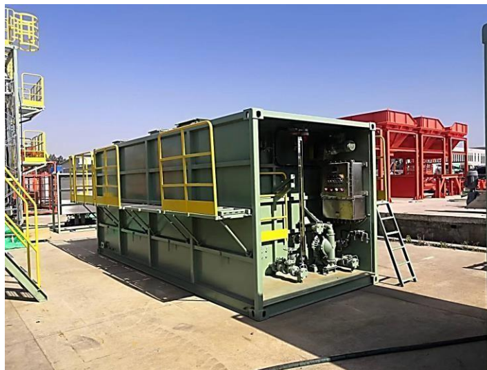
Figure III.13 : Équipement de séparation par sédimentation [63]
