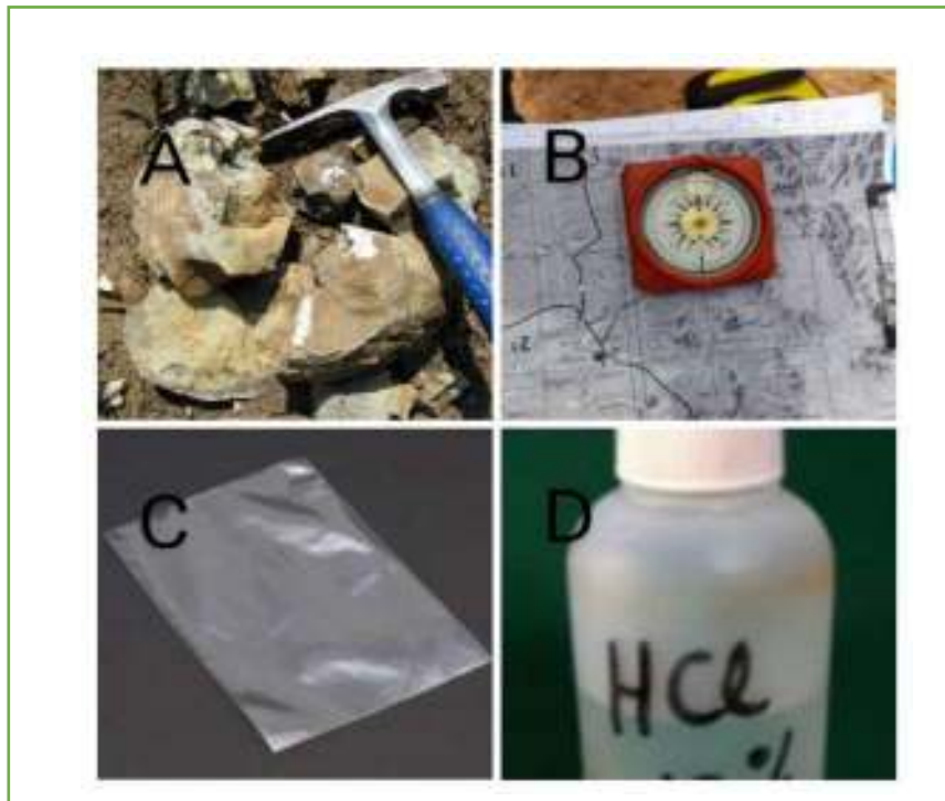
Figure 7 : Matériel de Terrain utilisé par les géologues(A) : Marteau géologique,( b) : boussole (C) : Sachet en plastique, (D) : HCl : Acide chlorhydrique (HCl)
