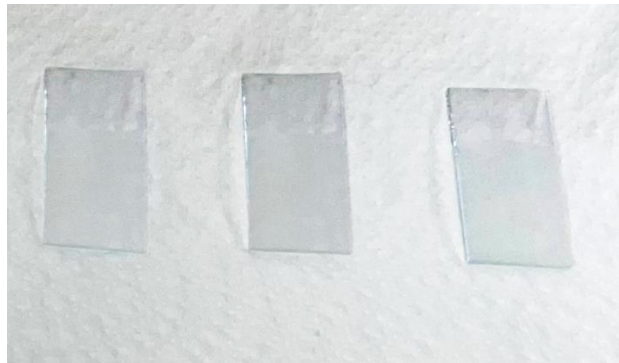
Figure II.4: Substrats d'ITO après l'électrodéposition du ZnO de 150 nm d'épaisseur.
