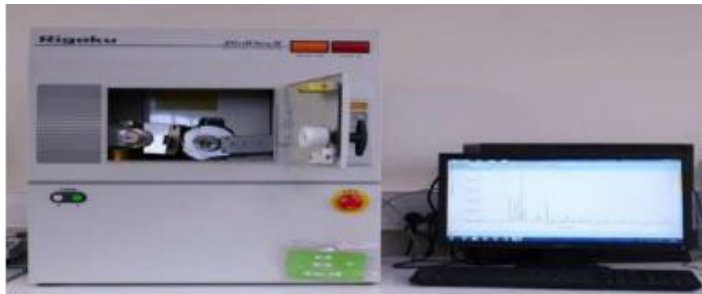
شكل II.15. صور لـ (أ): جهاز حيود الأشعة السينية و (ب): مطياف حيود الأشعة السينية. [47]
