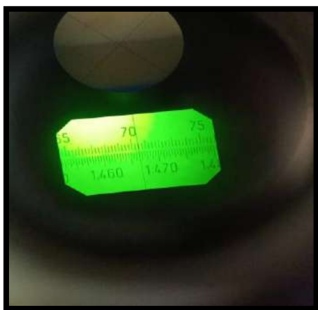
Figure V.07 : Champ de vision à l'intérieur du réfractomètre
