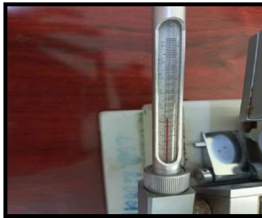
Figure V.08 : Lecture de la température dans le réfractomètre
