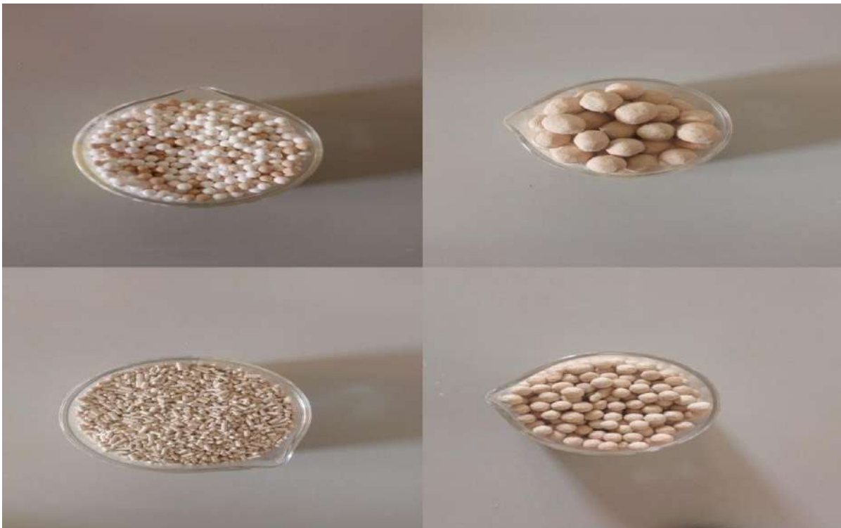
Figure II-3 : Assortiments de zéolithes naturelles à gauche et synthétiques (billes, cylindres extrudés) à droite. (Sources : photo SOMEZ)
