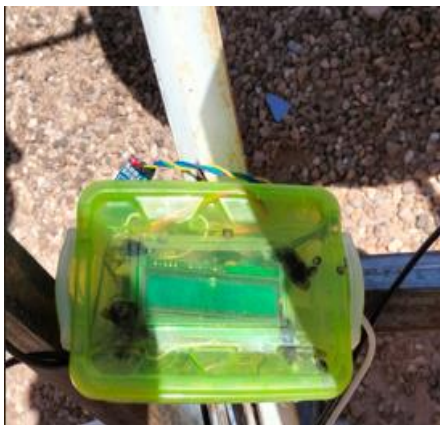
Figure 2.3 un système de contrôle électronique intelligent à l'aide d'une carte Arduino nanométrique.
