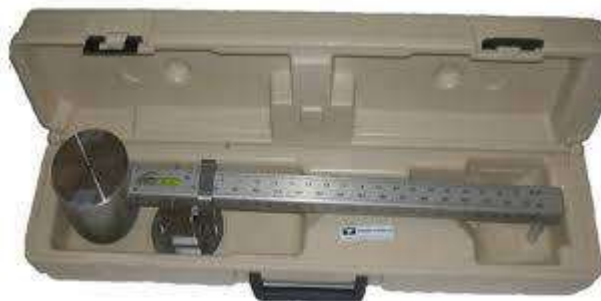
Figure IV.1. Densimètre à boue Méthode de mesure :
