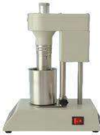
Figure 5 : Viscosimètre à cylindre Fannl
