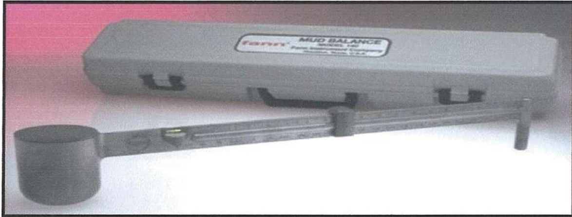
Figure IV.1. Densimètre à boue
