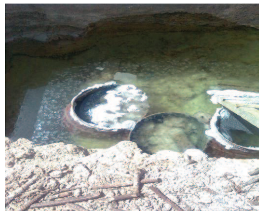
D: éprouvettes conservées dans La nappe phréatique
