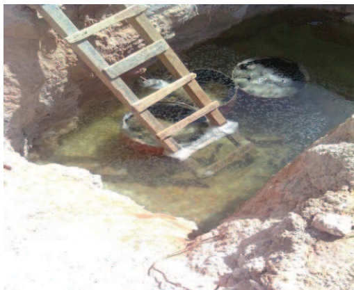
C: éprouvettes conservées dans La nappe phréatique
