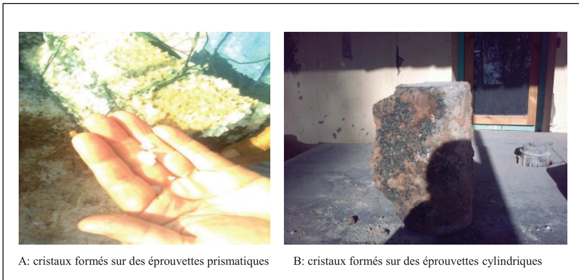
photo (IV-1): Éprouvettes lors de leur extraction des eaux de la nappe phréatique (Formation de cristaux a la surface).
