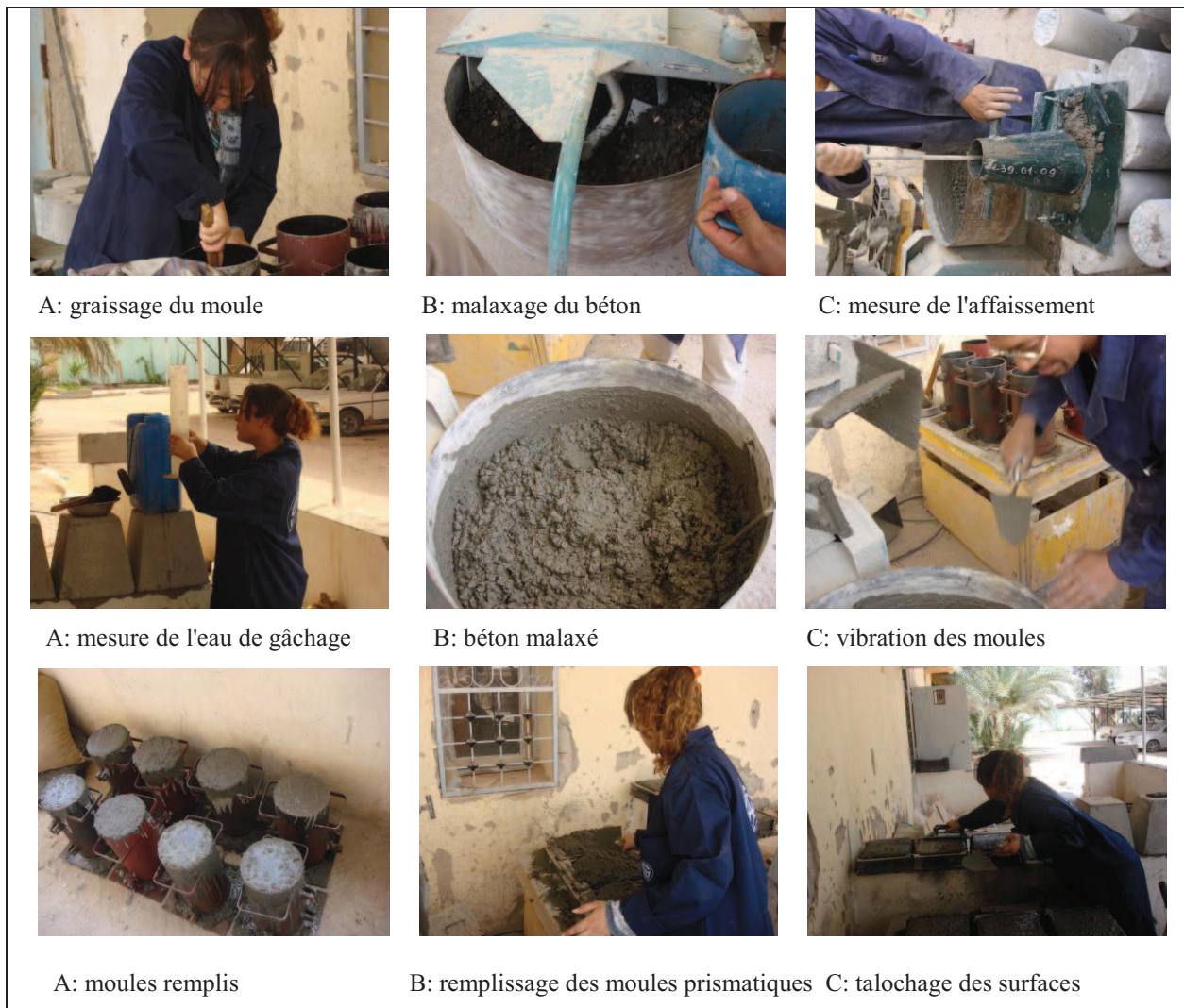
Photos (III-2): différentes étapes du remplissage des moules
