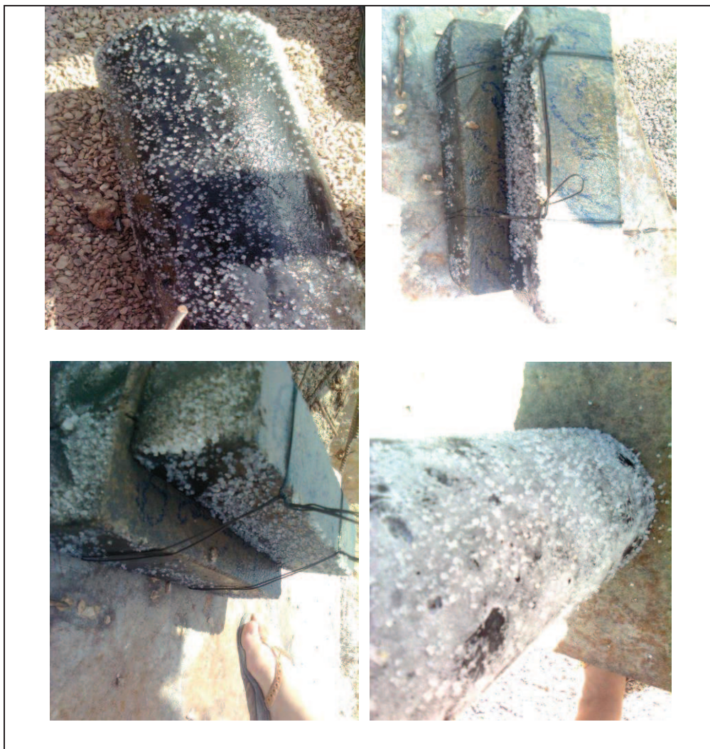
Photos (III-4): cristaux collés sur le béton conservé dans les eaux de la nappe
