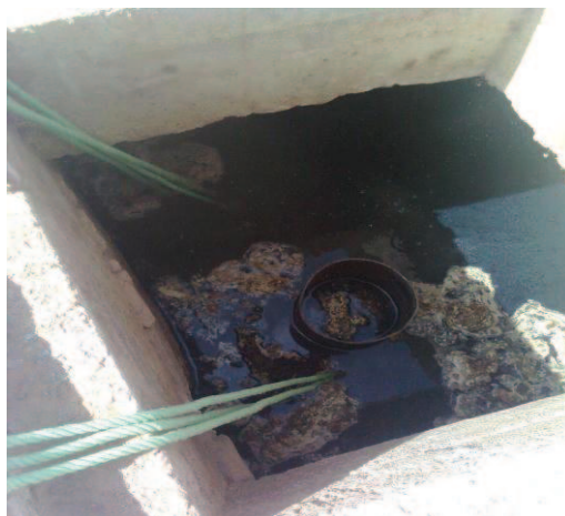
C: éprouvettes conservées dans les eaux usées
