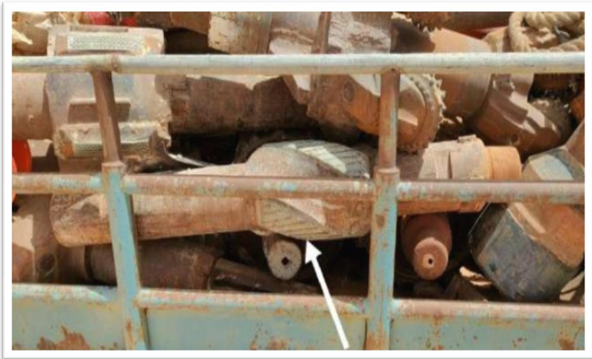
Figure 31: Stabilisateur à lames droites et obliques.
