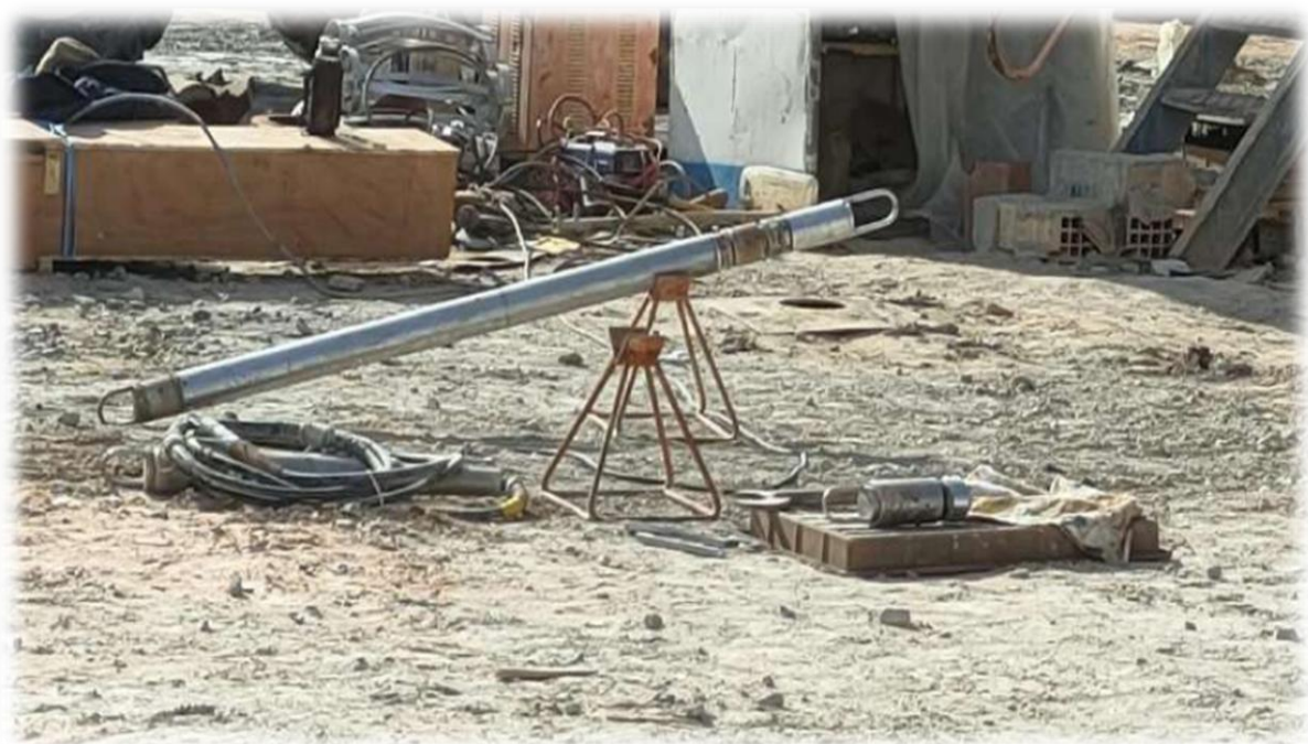
Figure 42: Sonde combinée (Gamma ray, polarisation spontanée, résistivité, électrique).
