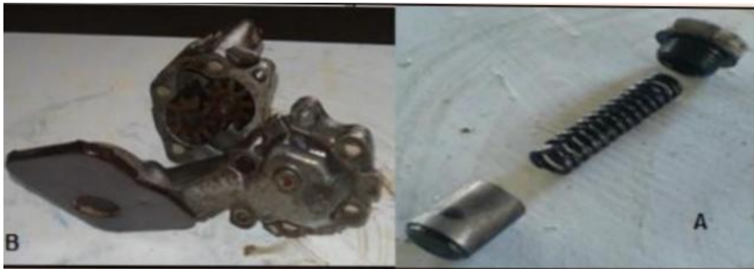
Figure (2.27) : A : Démontage de la soupape de sécurité de la pompe à huile.
