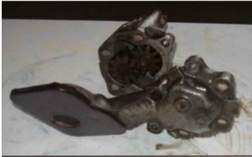
Figure (2.24) : Démontage de la pompe à huile.
