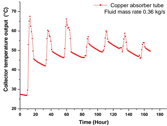
**Graph 3:** Water temperature outlet of from copper collecteur
