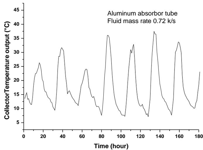
**Graph 6:** Water temperature outlet of from aluminm collecteur
