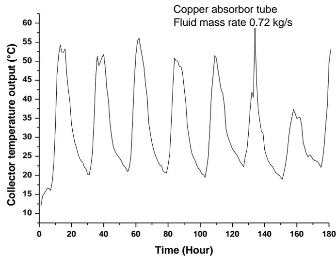
**Graph 5:** Water temperature outlet of from copper collecteur
