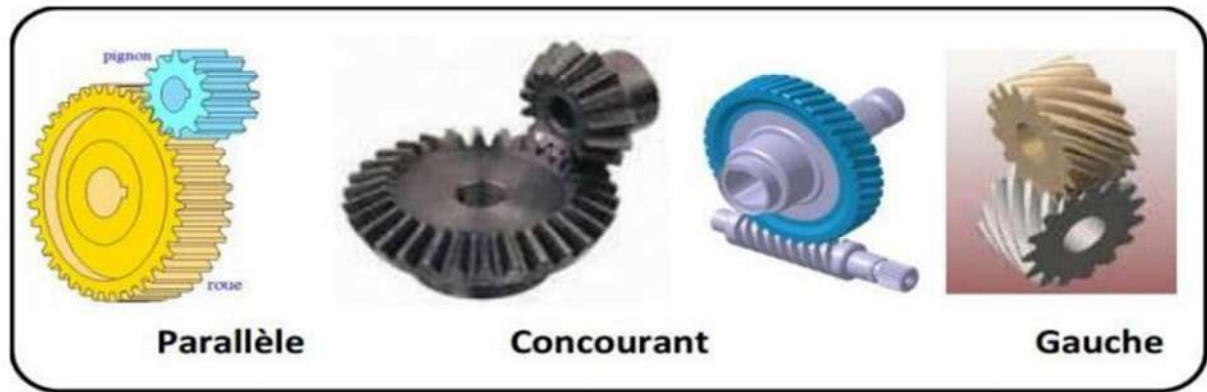
Figure III.14 différents types d'engrenage[12]
