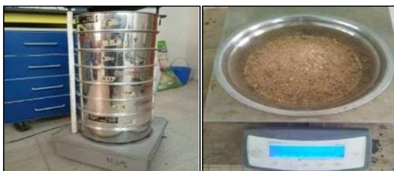
Photo II.4. Essai d'analyse granulométrique.
