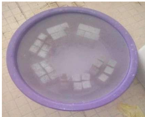
Photo II.10. Conservation des éprouvettes dans l'eau.
