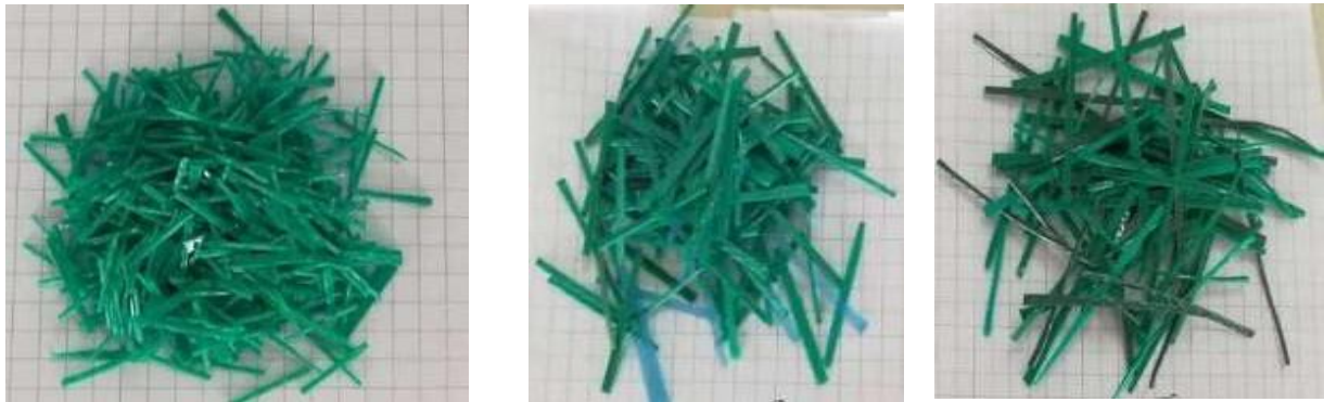
Photo II.6. La géométrie des fibres plastiques utilisées.
