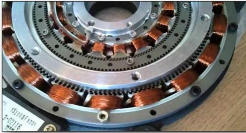
Figure I-21 MRV à effet vernier à stator externe et interne [4]
