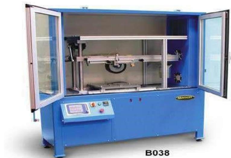
Figure 2.8 Appareillage de l'essai d'orniérage
