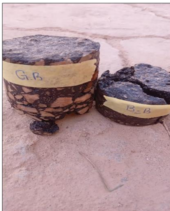
Image III.3 : Marquage et stockage des carottes
