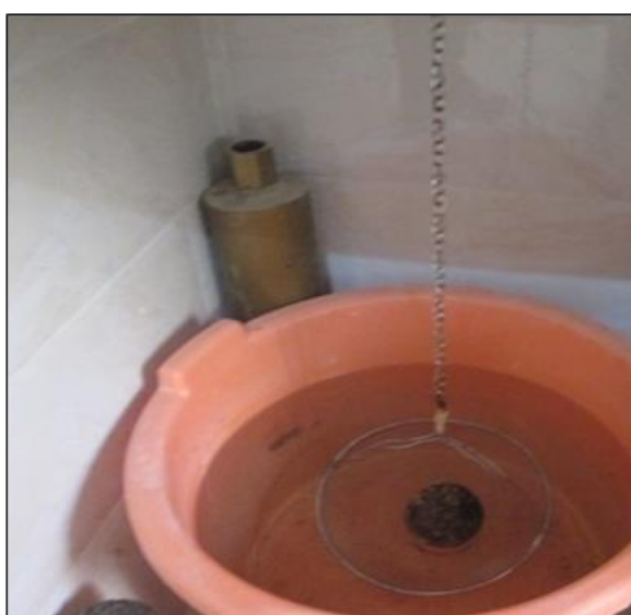
Image III.5 : Eprovette paraffinée dans l'eau
