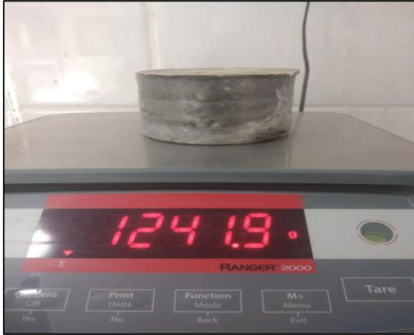
Photo III. 1: La masse volumique apparente par la méthode de la paraffine.
