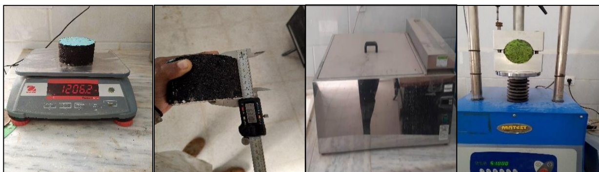
Photo III. 3 : Opérations de compression et de mesure de l'épaisseur des éprouvettes Marshall à l'aide d'un pied à coulisse.
