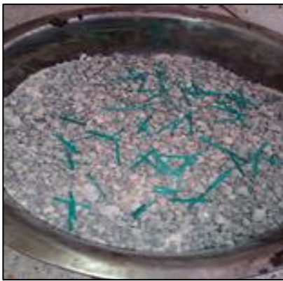
Photo III. 5 : Formulation du béton bitumineux par déchets plastique.
