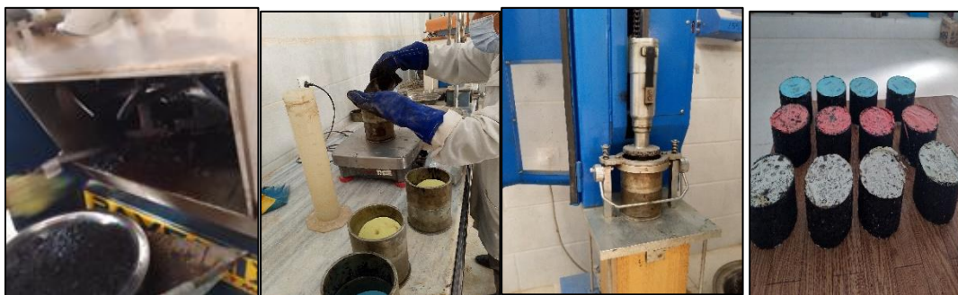
Photo III. 2 : Etapes de préparation du mélange bitumineux et éprouvettes.
