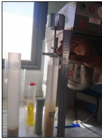
Photo II. 3: la détermination de l'équivalent de sable.
