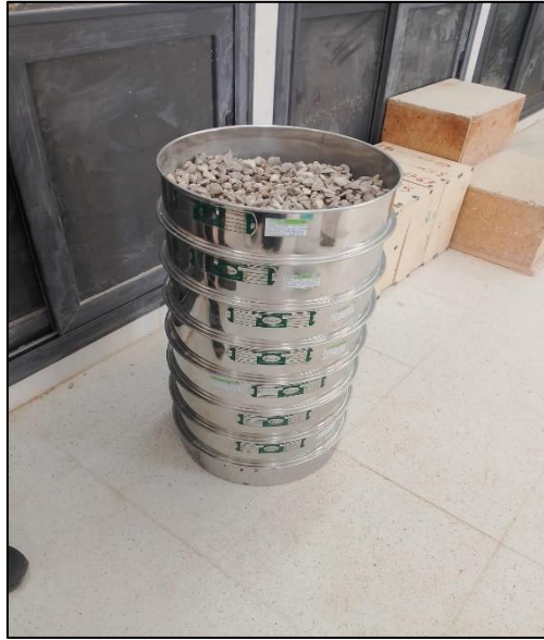
Photo II.1 : les essais d'analyse granulométrique.
