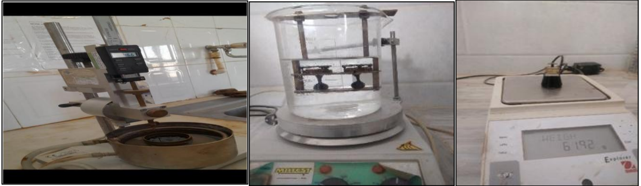
Photo II. 7 : Les outils utilisés pour mesurer les caractéristiques du liant utilise.
