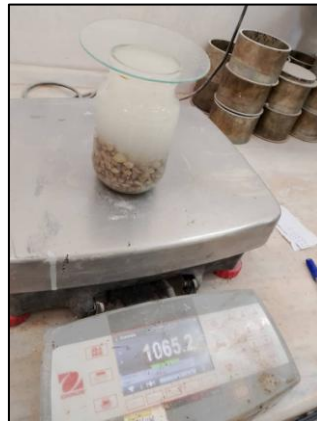
Photo II. 6 : Les mesurer de la masse volumique absolue.
