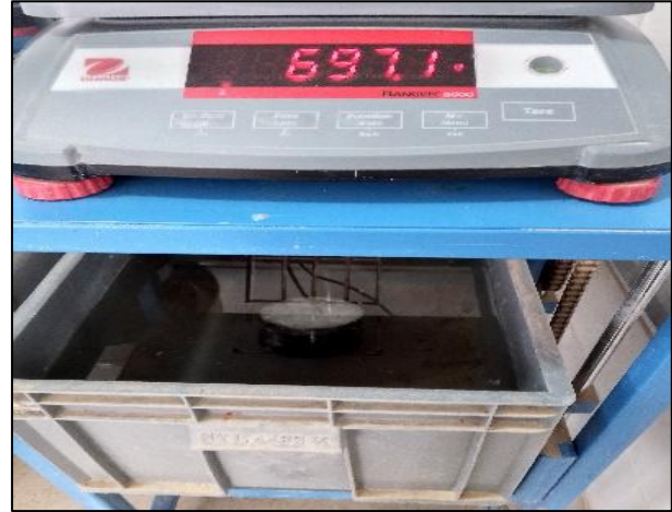
Photo III. 1: La masse volumique apparente par la méthode de la paraffine.
