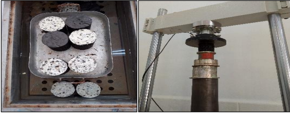
Photo III. 4: L'essai de Duriez.
