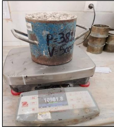
Photo II. 5 : Les mesurer de la masse volumique apparente.
