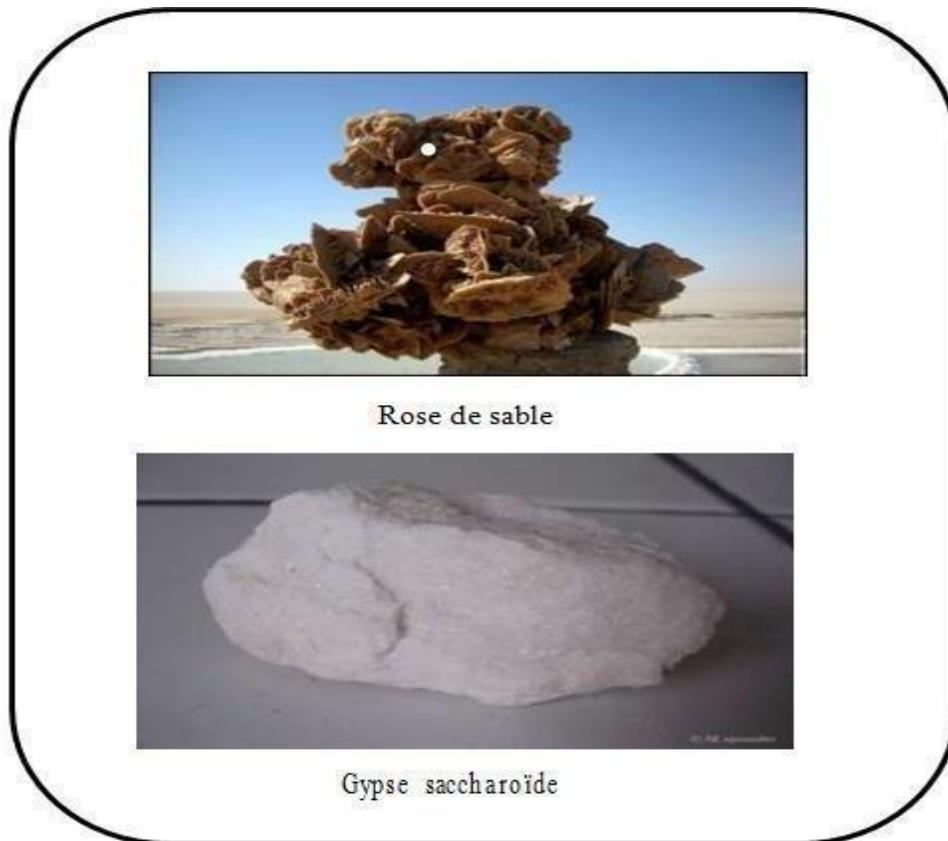
Figure II.1: Différents systèmes de cristallisation de gypse
