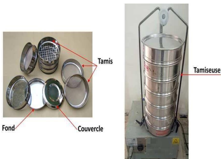
Figure III.3 Les tamis et la tamiseuse utilisés dans l'essai
