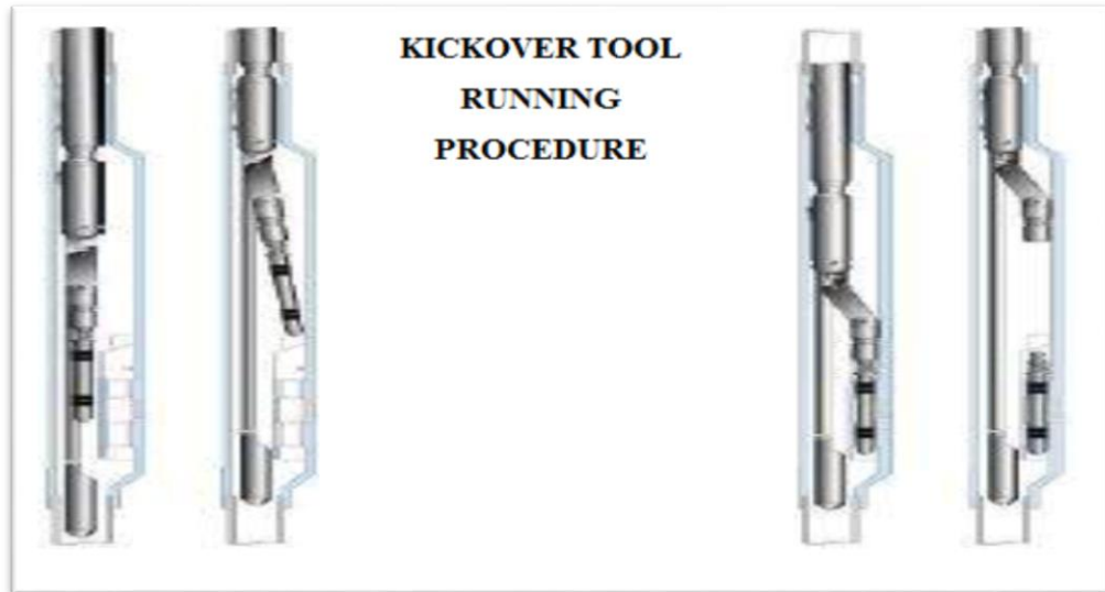
Figure II-7: Opération de mise en place d'une vanne de gaz lift par un kick over. [9]
