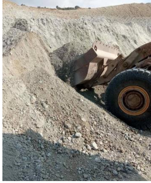
الصورة 3.I التيف الجيري-الجبسي
