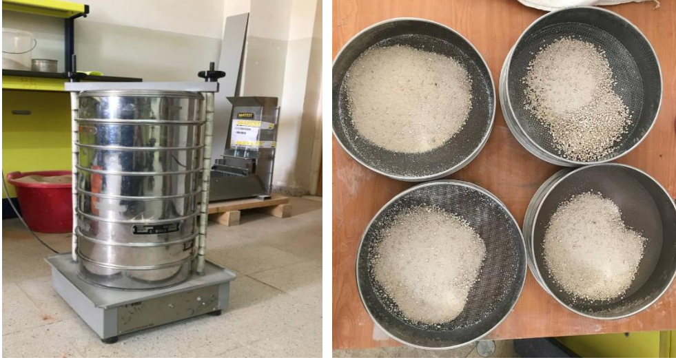
الصورة II.2 تجربة التدرج الحبيبي
