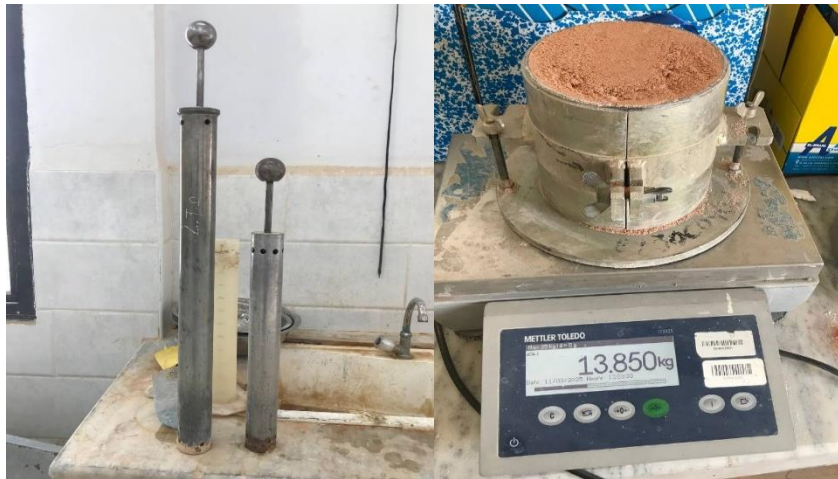
الصورة 3.II تجربة بروكتور المعدل
