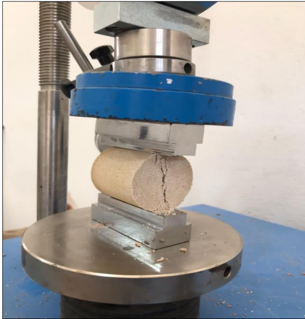
الصورة 6.III عينة اثناء التكسير
