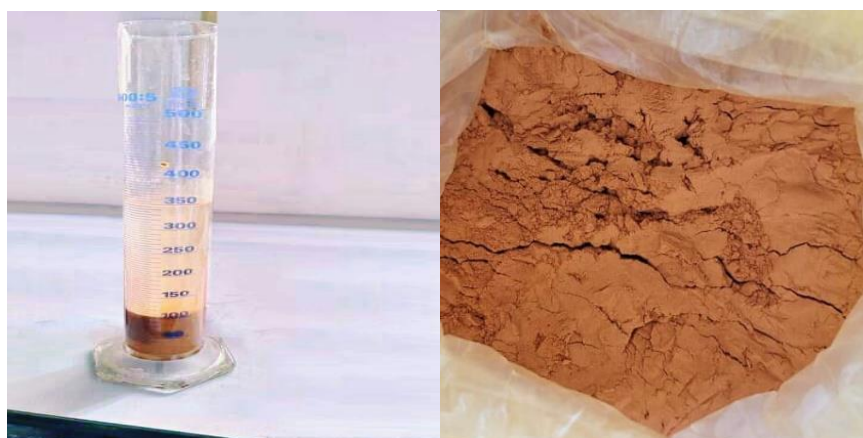
الصورة 8.II : تجربة الكتلة الحجمية المطلقة على مسحوق الطوب
