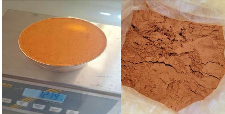
الصورة II.7 تجربة الكتلة الحجمية الظاهرية على مسحوق الطوب
