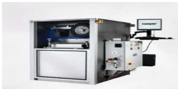
Figure 1.13. Machine d'orniérage (orniéreur) [18]
