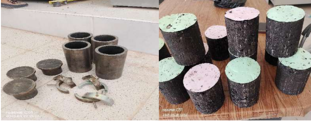
الصورة 9.IV: صورة تمثل عينات وقوالب اختبار دورياز .
