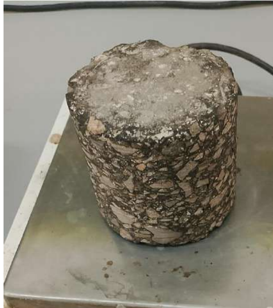
الصورة 11.IV : يمثل صورة من التجربة الميدانية للعيينة الاسطوانية وجهاز الحفر .
