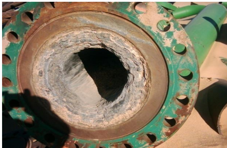
Fig.II.7: dépôt de sel contenant le \text{BaSO}_4
