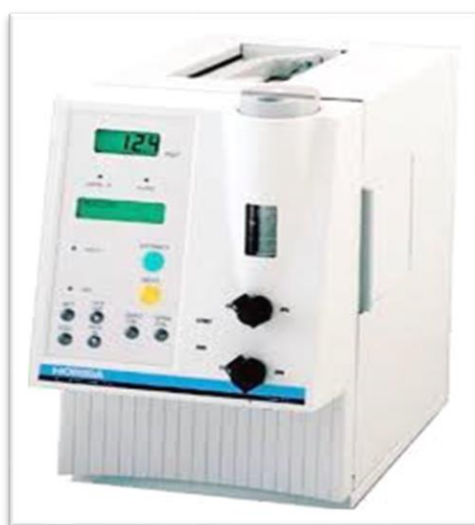
Fig.III.4: Système d'analyse de teneur en huile, HORIBA OCMA-310.
