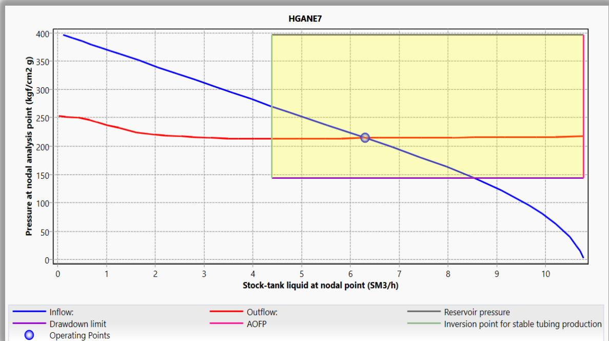
Figure 21: Point de Fonctionnement du puits HGANE7 après actualisation.
