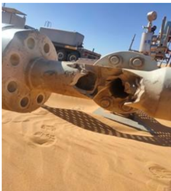
FIGURE 2.13 – Érosion des équipements de surface par écoulement sableux
