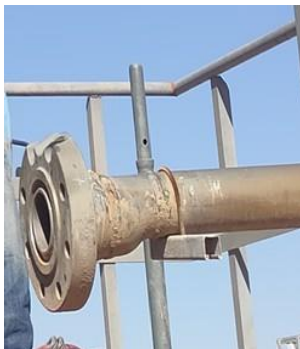
FIGURE 2.13 – Érosion des équipements de surface par écoulement sableux
