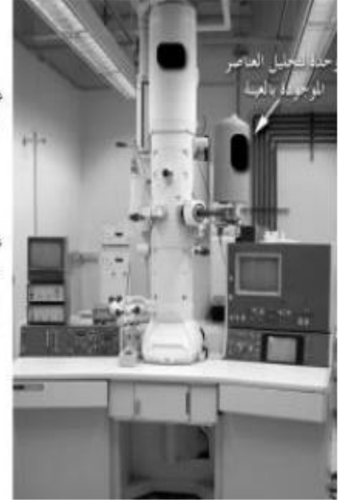
الشكل 13-1: صورة للمجهر النافذ الإلكتروني إضافة إلى رسم تخطيطي له يبين مكوناته الداخلية
