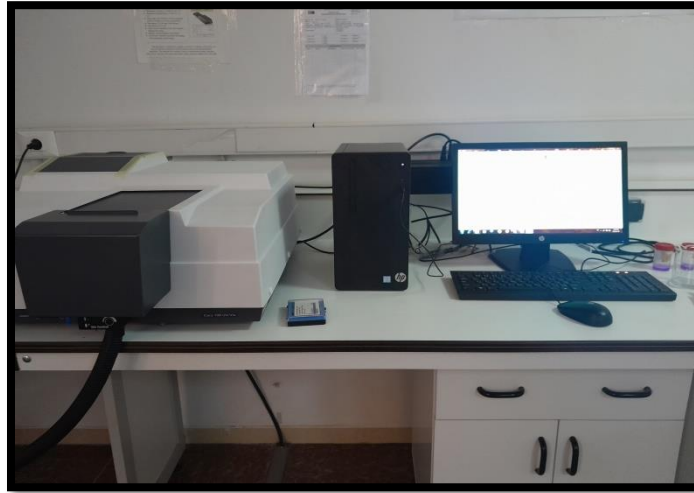
الشكل 8.III: مطيافية الأشعة فوق البنفسجية والمرئية
