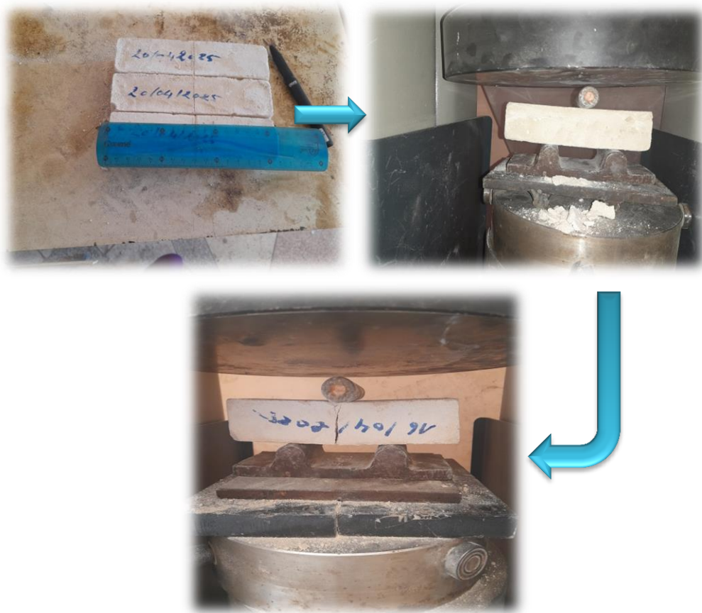
Figure 29: Les étapes de teste de traction flexion.
