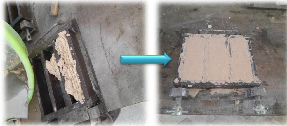
Figure 23: le remplissage des moules.
