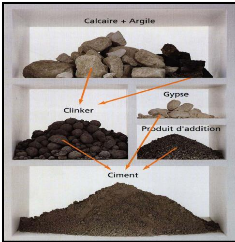
Figure 12: La chaine de fabrication du ciment.
