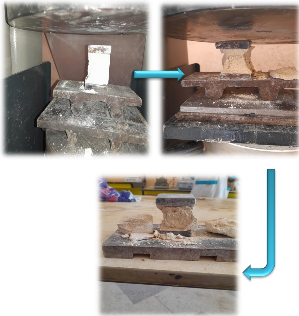
Figure 31: Les étapes de teste de compression.
