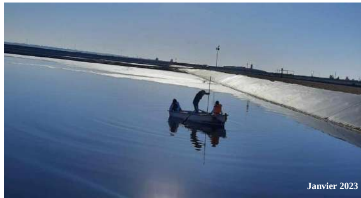
Figure18. Mesure de l'épaisseur des sédiments.
