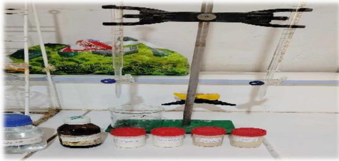
Photo : détermination d'acidité dornic
