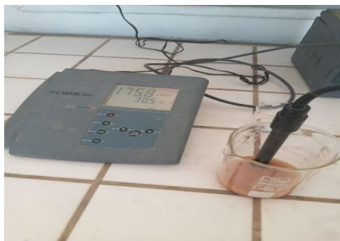
Fig. 12– Mesurer CE de la solution à l'aide d'un cond 720 -mètre
