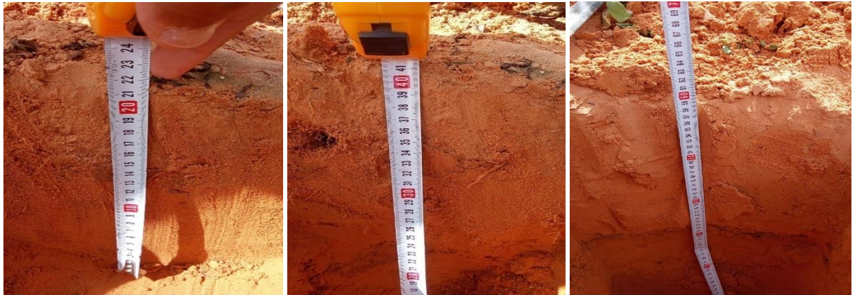
Fig.10- Méthode de collecte des échantillons de sols en fonction des profondeurs
