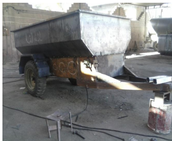
Photo n° 21 : Fabrication locale des remorques (EL-oued )
