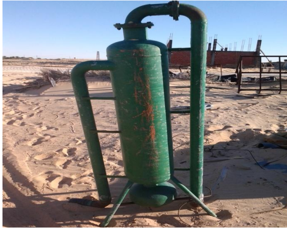
Photo n° 22 : Filtres pour système goutte à goutte fabriqués localement (EL-oued)
