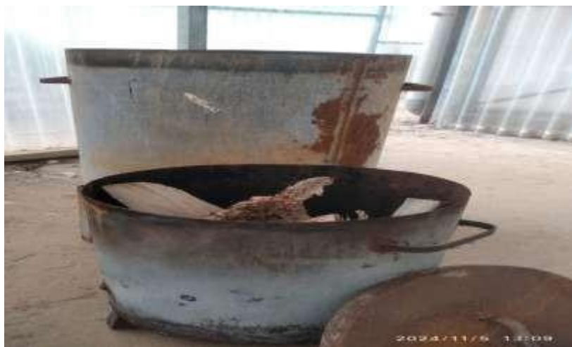
Photo 03 : Préparation du biochar dans un four à pyrolyse
