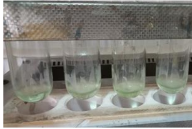
Kjeldahl Speed Digester (BUCHI)
