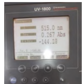
c) Mesurer l'absorbance à 515 nm par un spectrophotomètre UV-Visible.
