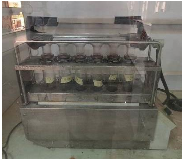
Kjeldahl Speed Digester (BUCHI)
