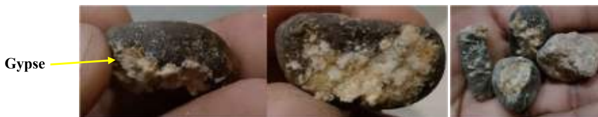
Figure III. 3 - Accumulation secondaire du gypse (Barbe de gypse)
