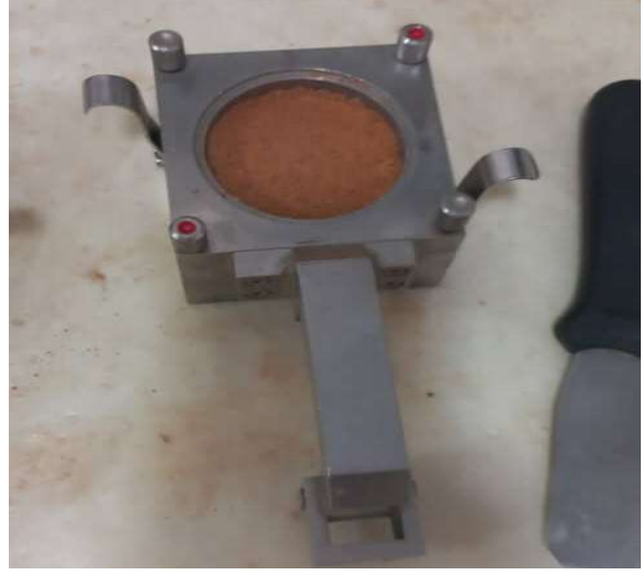
الشكل III.1 : تحضير عينات للتجربة القص
