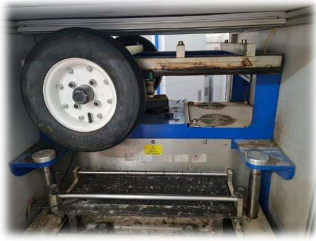
الصورة (IV-16): جهاز تجربة التحدد.
