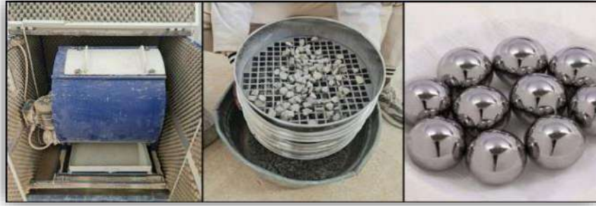
الصورة (III-06): توضح أدوات تجربة لوس أنجلوس.
