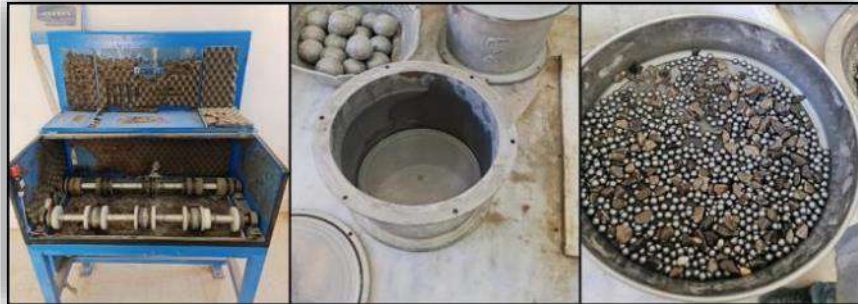
الصورة (III-07): توضح أدوات تجربة ميكرو دوفال (MDE).
