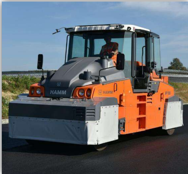
الصورة (II-04): ضاغطات الإطارات الهوائية.
