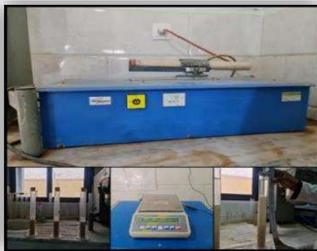
الصورة(III-08): توضح أدوات تجربة مكافئ الرمل.
