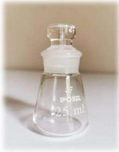
الصورة (III-11): مقياس البيكنومتر
