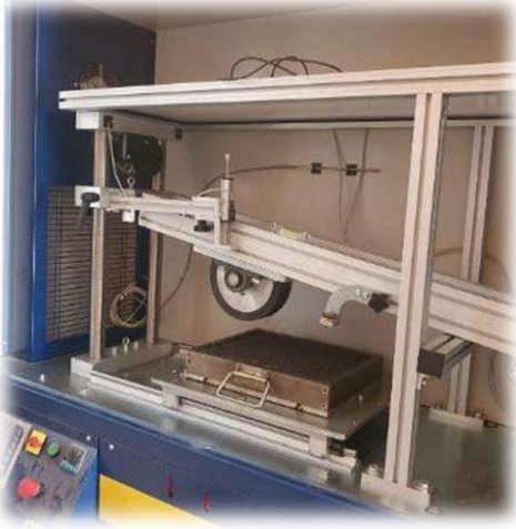
الصورة (IV-17): جهاز تجربة التحدد.
