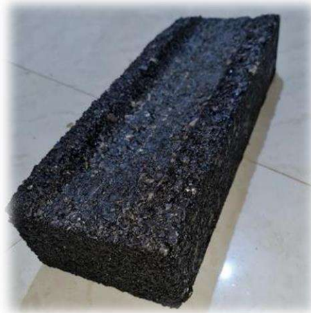
الصورة (IV-19): العينة بعد وصولها لمتوسط عمق التحدد.
