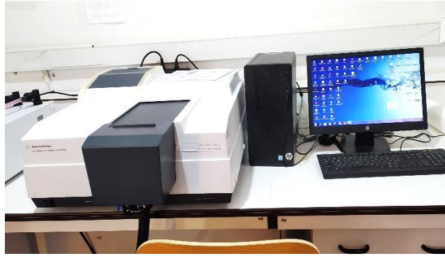
الشكل (17.5.11): جهاز الأشعة فوق بنفسجية - المرئية UV-Visible.
