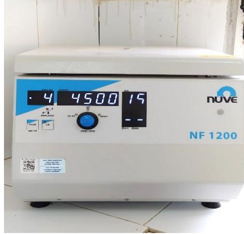
الشكل (16.4.11): جهاز الطرد المركزي المستعمل من نوع NF1200.
