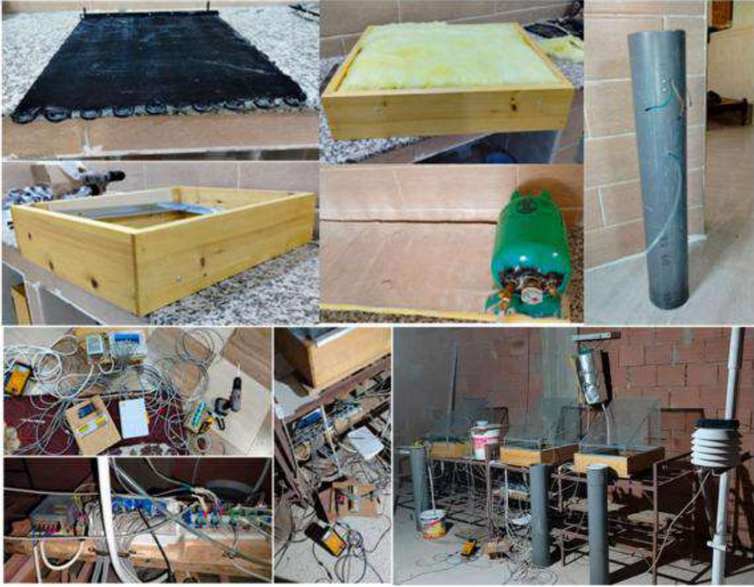
الشكل 1 A: خطوات تركيب المقطرات الشمسية و وحدة التحكم اوردوينو
