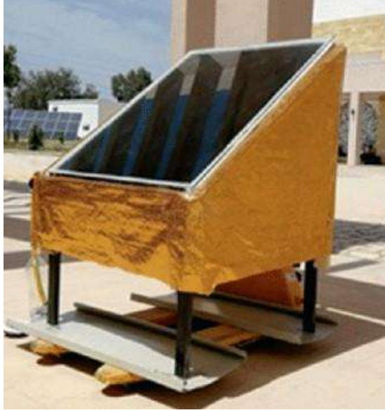
الشكل 1-8: المقطر الشمسي أحادي الميل (Chemkhi & Madiouli, 2022)
