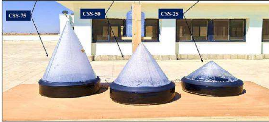
الشكل 1-13: المقطر الشمسي المخروطي (Kabeel et al., 2024)
