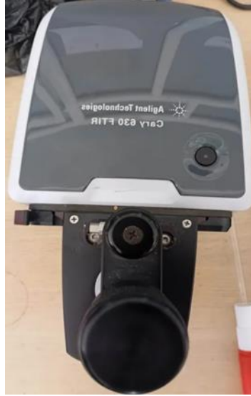
الشكل II - 17: جهاز مطيافية الأشعة تحت الحمراء بتحويل فورييه (FTIR) من نوع Agilent Technologies Cary 630 FTIR
