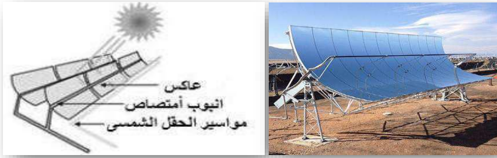
الشكل (II-4): المجمع الشمسي الأسطواني القطع مكافئ. [6]
